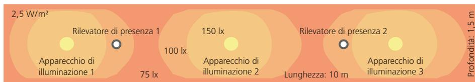
Proiezione orizzontale di un corridoio con apparecchi di illuminazione e curve Isolux
